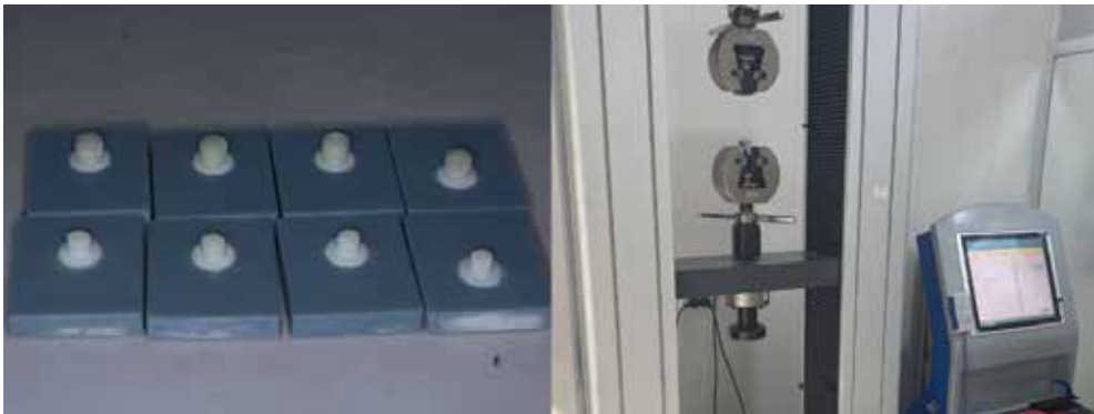
Hình 1. Khối chất gắn được dán lên bề mặt sứ và đo độ bền dán
