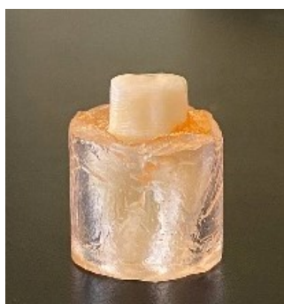
Hình 1. Mẫu được đổ khuôn nhựa Epoxy
