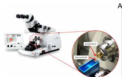
Hình 7. Máy cắt siêu mỏng, lưới gắn dao kim cương (A) và các loại lưới đỡ mẫu (B)
